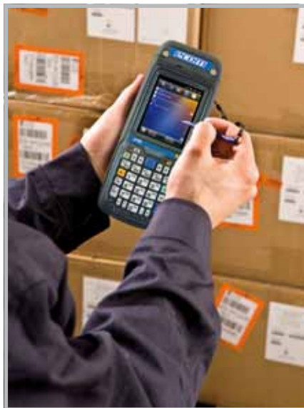
Der i.roc® Ci70 -Ex ermöglicht mobile Datenerfassung auch in Zone 1.
