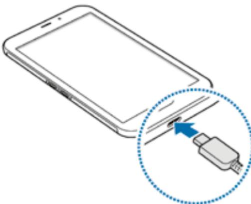
3 Conecte el adaptador de alimentación USB a una toma de corriente.
